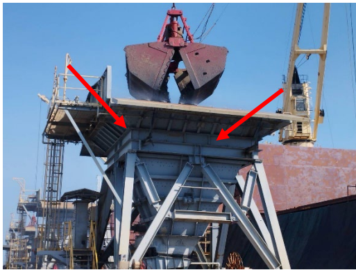
ภาพที่ 2-3 การฉีดพรมน้ำในระหว่างขนถ่าย ถ่านหินจากเรือลงบนฮอปเปอร์รับถ่านหิน
