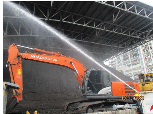
ภาพที่ 2-4 การฉีดพรมน้ำบนกองถ่านหิน
